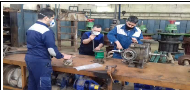
مونتاژ پمپ رزرو Hoc توسط تلاشگران اداره پمپها
