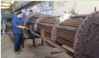
ساخت کامل کوئل کولر بخار استارت بویلر در کارگاه ساخت میل های حرارتی نیروگاه رامین اهواز
