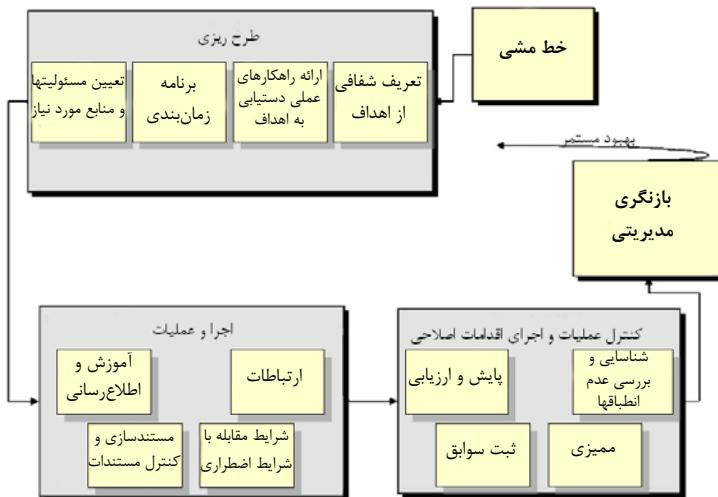
شکل (۳): سیستم مدیریت HSE براساس چرخه دمینگ
