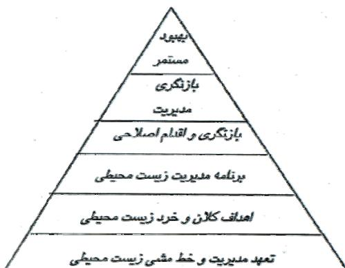
شکل (۳): ساختار سیستم مدیریت زیست محیطی
